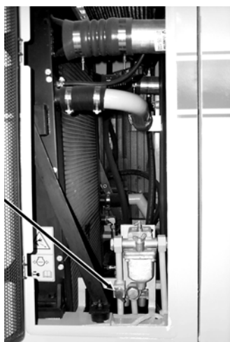
Рис. 4.12. Клапан отбора воздуха для накачки шин
