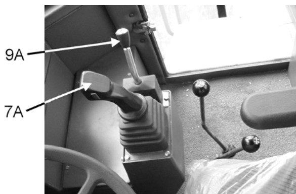
Рис. 4.2а. Рычаг управления рабочей системой (модификация машины с однорычажным управлением)
