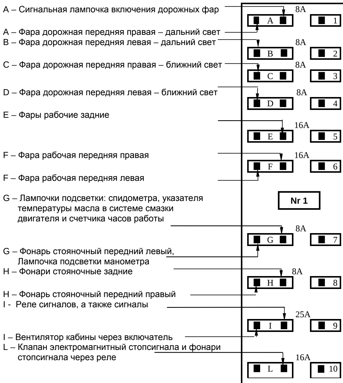
Рис. 4.5. Коробка предохранителей на 10 предохранителей, левая
