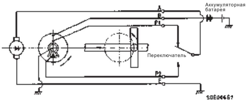
Если переключатель переместить в сторону **P1** (пусковой включатель в положении ВЫКЛ), то электрический ток протекает от контактной пластины плюсовой стороны через клемму автоматической остановки **P1** и переключатель,
