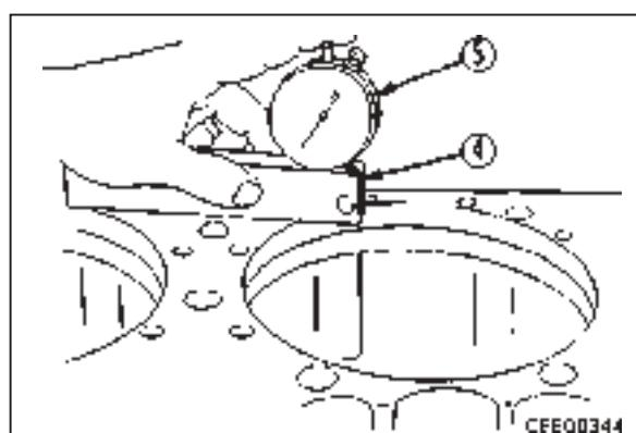
**Измерение отверстия гнезда коренного подшипника**
