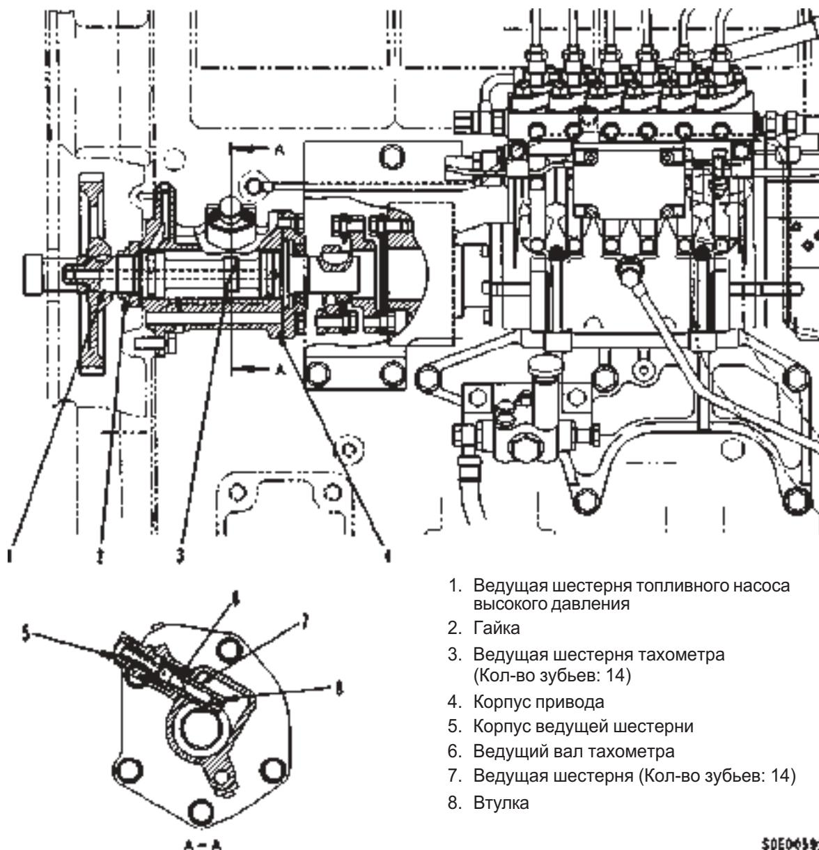
1. Ведущая шестерня топливного насоса высокого давления
