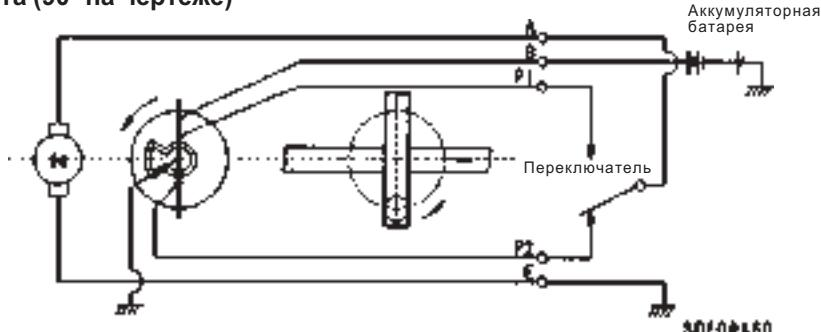
Электрический ток продолжает проходить через якорь в сборе, и мотор продолжает вращаться. Из-за вращения ролика ползун в сборе также
