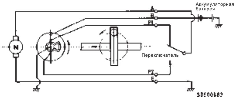
Электрический ток продолжает протекать через якорь в сборе, и мотор продолжает поворачиваться. Из-за вращения ролика ползун в сборе также продолжает поворачиваться в направле-
