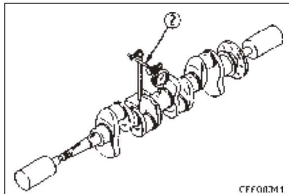
**Измерение наружного диаметра шеек коленвала**
