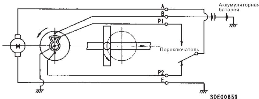
Если переключатель переместить в сторону  $P_2$  (пусковой выключатель в положении ВКЛ), то электрический ток протекает от контактной пластины плюсовой стороны через клемму автоматической остановки  $P_2$  и переключатель,
