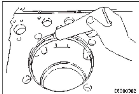
★ Сечение слоя уплотнителя: 2,0 - 3,0 мм
