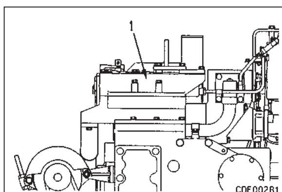
**39. Предохранитель от коррозии**
