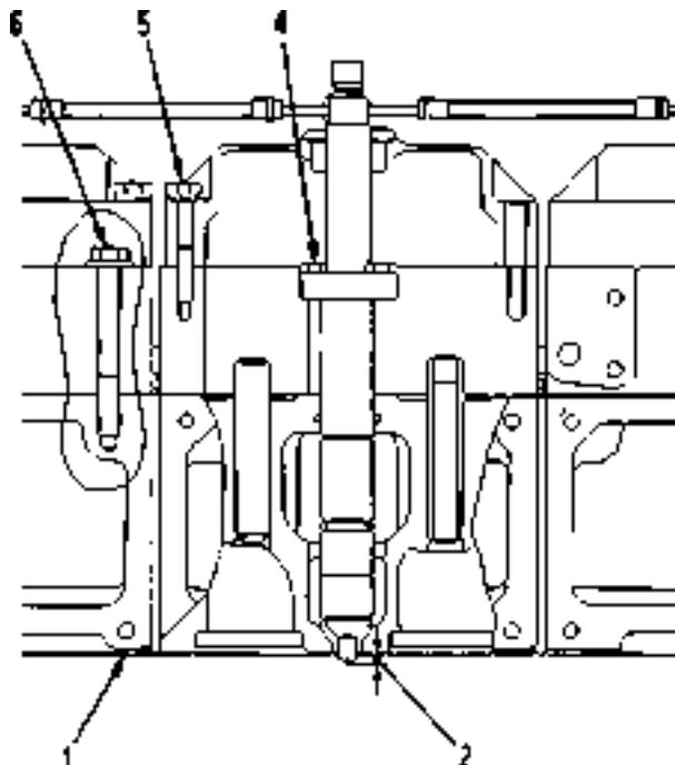
Порядок затяжки монтажного болта головки
