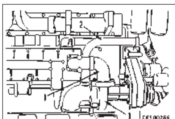
**53. Теплоизоляционные крышки (только для D275A-2, D375-3, PC1000-1 в исполнении для внутреннего рынка)**
