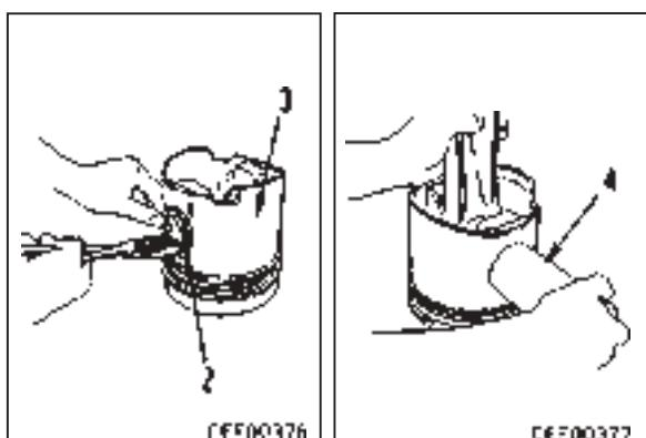
5) Нанесите на поверхность бобышки поршня моторное масло (SAE30). Убедившись в том, что литая метка, обозначающая переднюю часть поршня, и литой номер на шатуне обращены в одну и ту же сторону, вставьте поршневой палец (4) и соберите поршень с шатуном.
