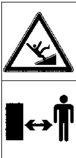
Табличка 18 Держаться вдали от жатки: прежде чем приступать к техническому обслуживанию или очистке жатки, отключить ее орган управления, остановить двигатель и вынуть ключ зажигания.
