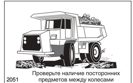
Запрещается «вытряхивать» налипший или примерзший груз из кузова, ударяя задними колесами в упорный брус, или иным способом встряхивая поднятый кузов. При этом создается очень большая нагрузка на поворотные пальцы кузова, раму и гидравлическую систему, что может стать причиной повреждений.
