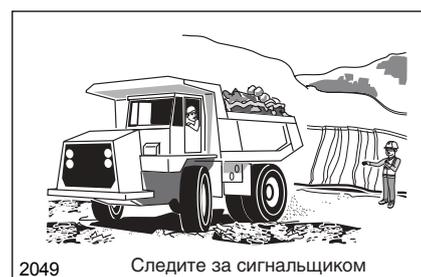
Прежде, чем поднимать кузов, убедитесь, что задние колеса находятся на твердой ровной площадке. Если одно колесо находится выше другого, на пальцы цилиндров кузова, цилиндры и раму автомобиля воздействует скручивающая нагрузка. Остановите автомобиль, уменьшите обороты двигателя до холостых, включите нейтральную передачу и затормозите автомобиль стояночным / аварийным тормозом для удержания его на месте.
