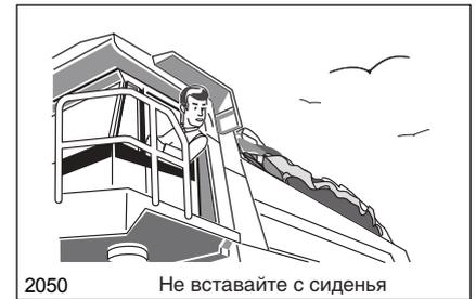
Переведите рычаг подъема кузова назад, в положение «ПОДЪЕМ», и увеличьте обороты двигателя. При приближении кузова к крайнему положению уменьшайте обороты двигателя. После того, как кузов поднимется до нужной высоты, переведите рычаг в положение удержания, чтобы удерживать кузов до момента опускания. После того, как штоки подъемных цилиндров выдвинутся полностью, не держите рычаг в положении «ПОДЪЕМ» во избежание ненужной работы предохранительного клапана гидравлической системы.
