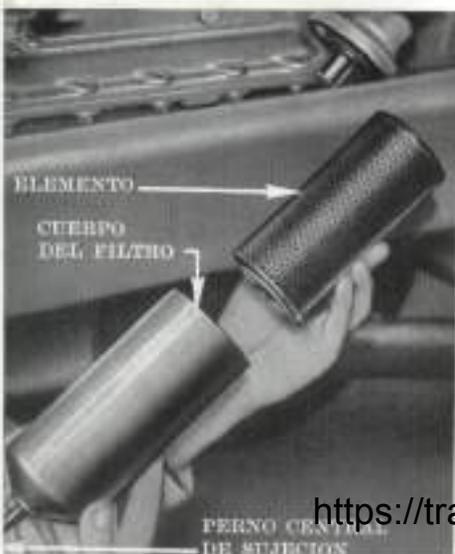
Fig. 9. — Elemento del filtro de aceite del motor
