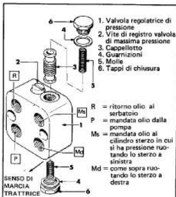
Figura 34. Taratura valvola idroguida (caso "B")
