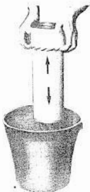
FIG. 42 - Lavage de la cartouche filtrante
