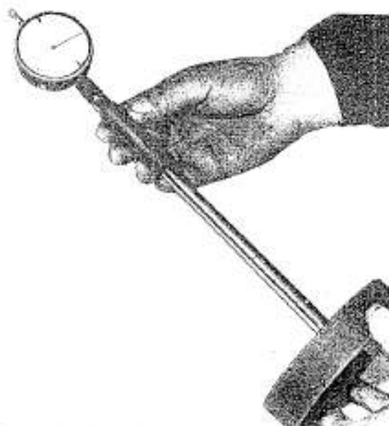
FIG. 9 - Emploi de la cale-étalon
