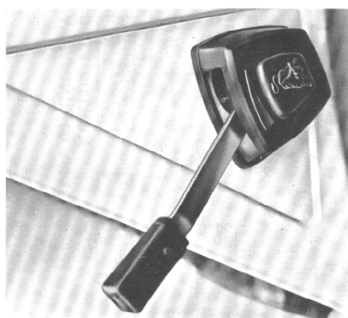
FIG. 4. Leva comando acceleratore
