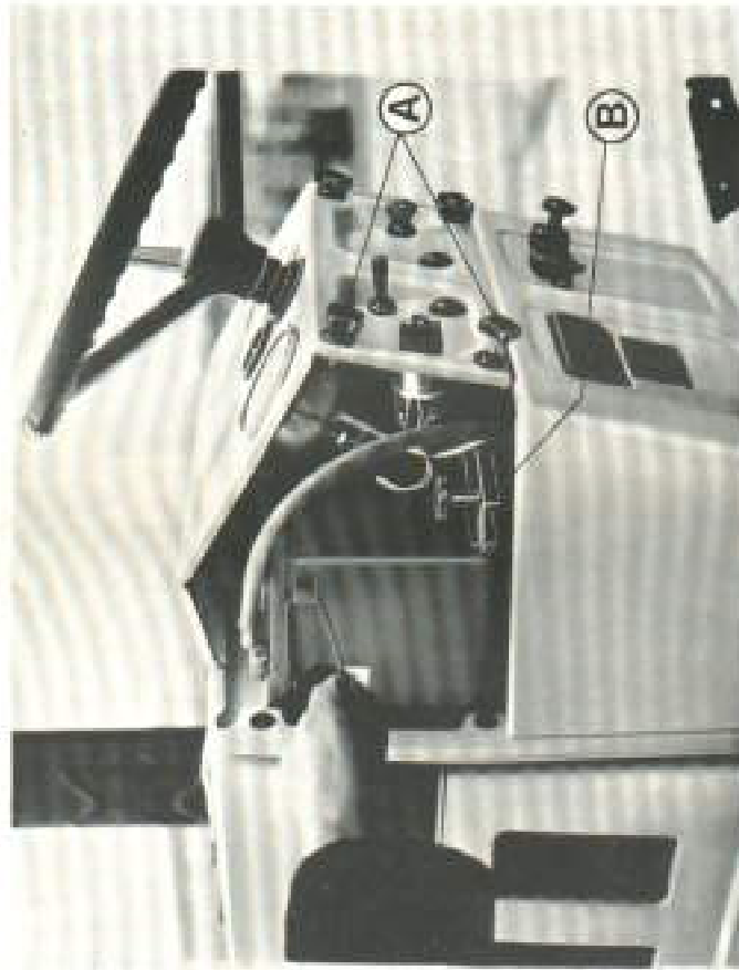
FIG. 20 - A: Pomelli fissaggio fianchetti laterali B: Staffa fissaggio batterie
