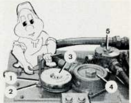
Emplacement de la vanne de fermeture sur le réservoir du circuit hydraulique.
