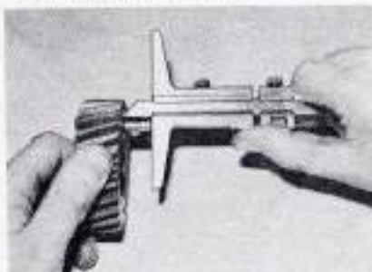
La goupille tubulaire doit dépasser de 17 mm le pignon de vilebrequin.
