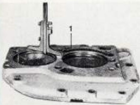
Relevé de la profondeur du logement du roulement à billes de l'arbre intermédiaire dans la plaque.
