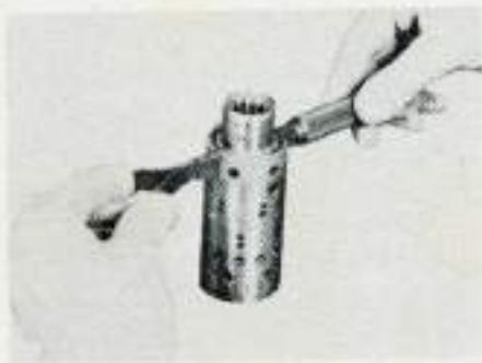
Mise en place des lames ressort sur le manchon et tambour.
