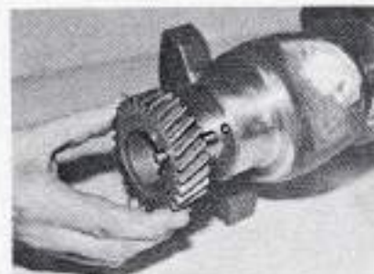
Mise en place du pignon sur le vilebrequin.
