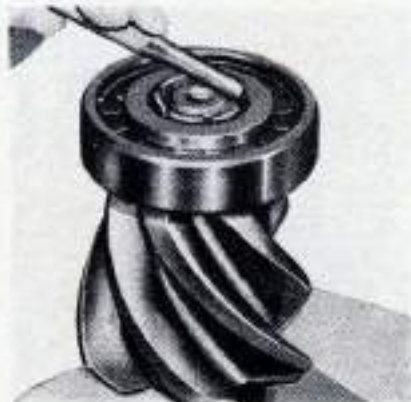
Sertissage du roulement pilote sur le pignon d'attaque.
