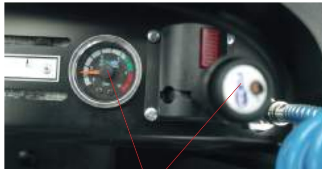
Clapet de frein de stationnement et manomètre
