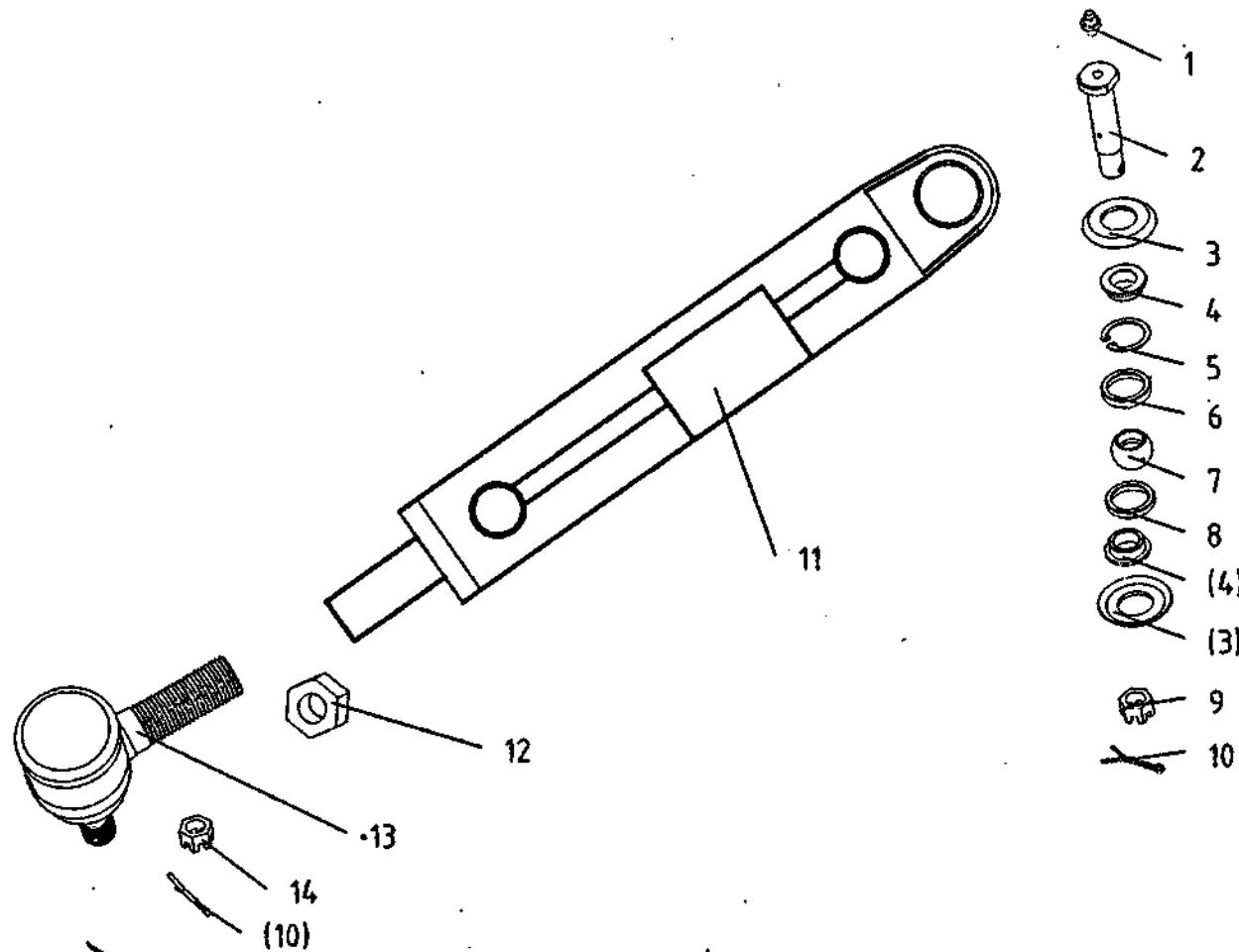
15. 2. B 油缸拉杆总成Cylinder Rod Assembly
