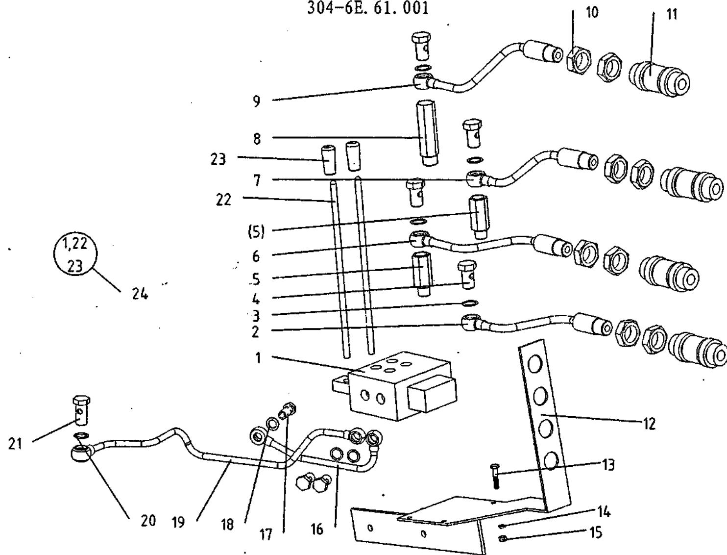
29 多路阀液压输出系统总成 Sandwich Multiole Control Valve
