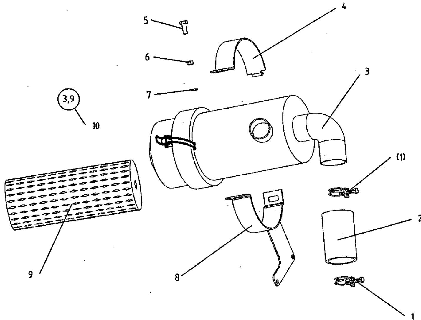
1. B 空滤器总成(干式) Air Filter(Dry Type)
