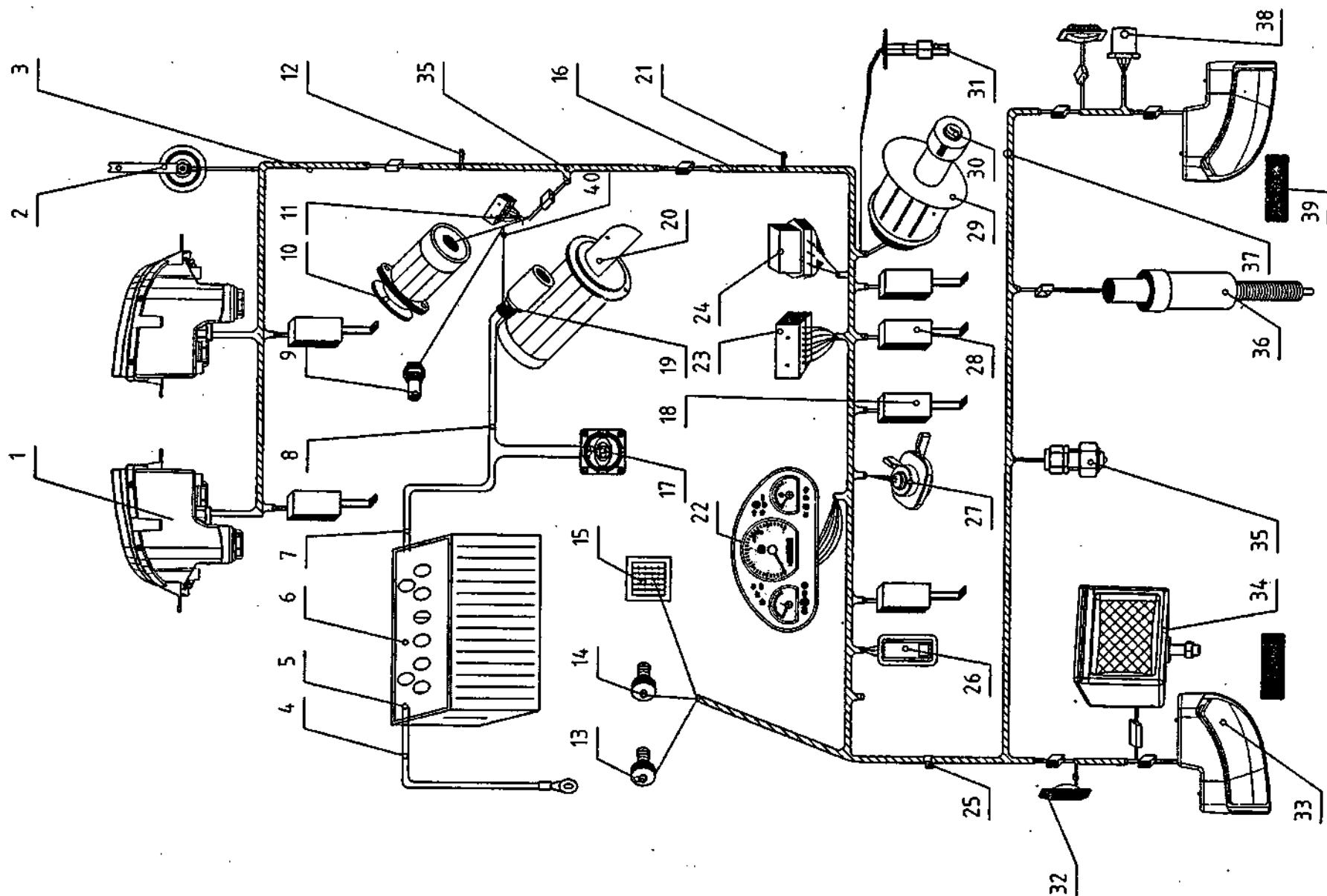
22. A 电气系统总成 (组合仪表) Electrical System (Combination Meter)
