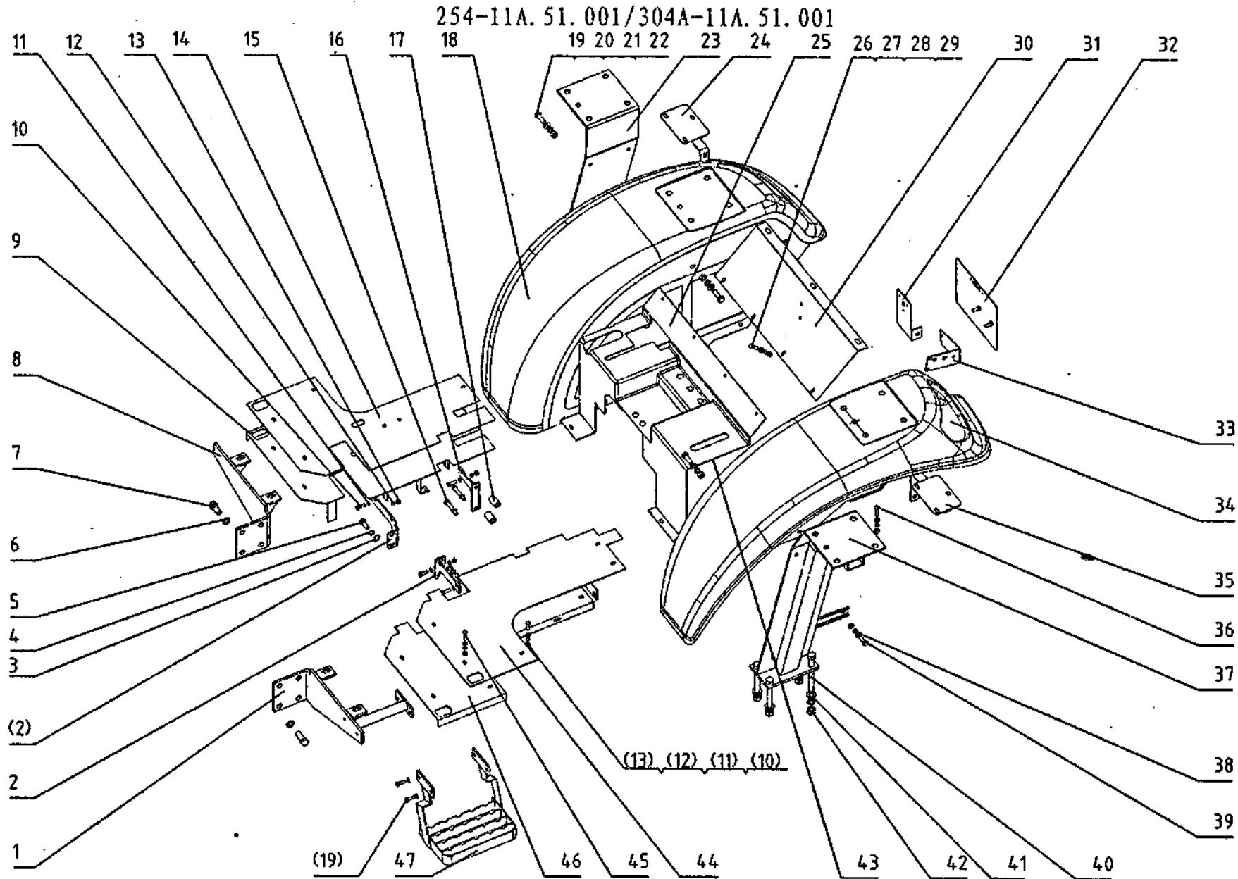
25. A 地板挡泥板总成 Foot Mud Shields Rest
