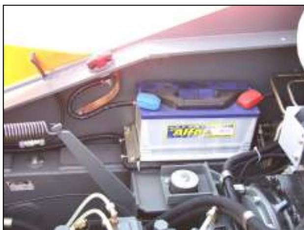
*Рис. 18– Местонахождение аккумулятора*
