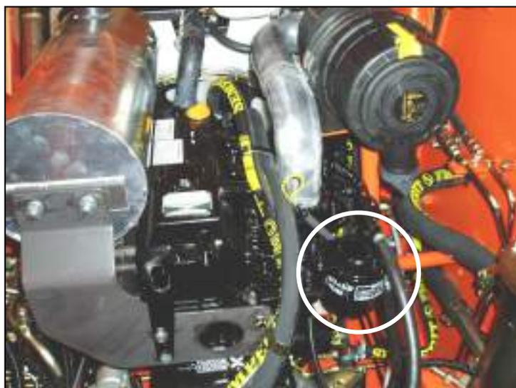
**Рис. 36 Топливный фильтр**
