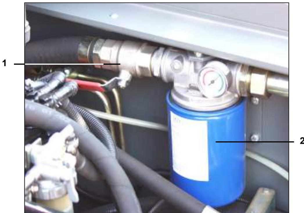
**Рис. 38– Местонахождение фильтра масла гидравлического контура ходовой части**
