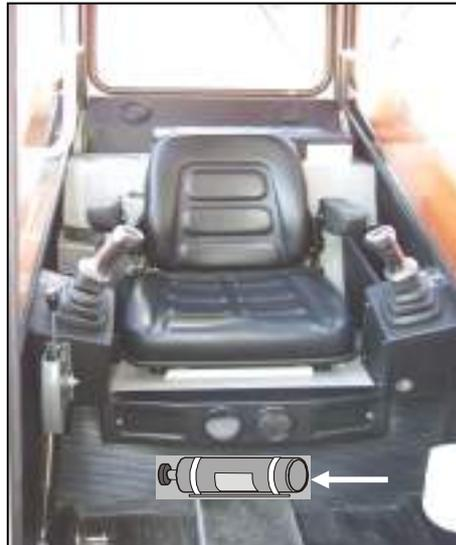
**Рис. 5** Размещение огнетушителя.
