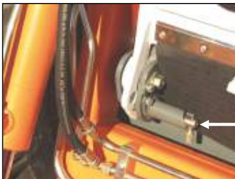
*Рис. 28– Предохранитель откинутой кабины*
