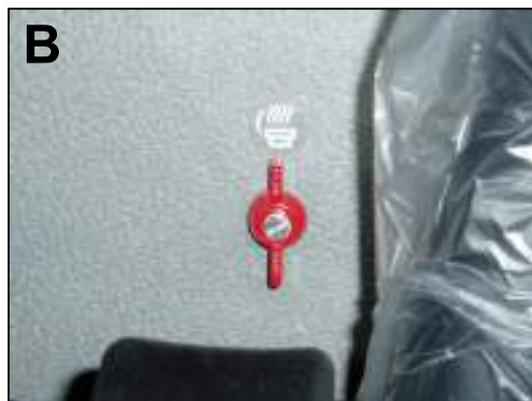
*Рис. 27В- клапан открыт - отопление*
