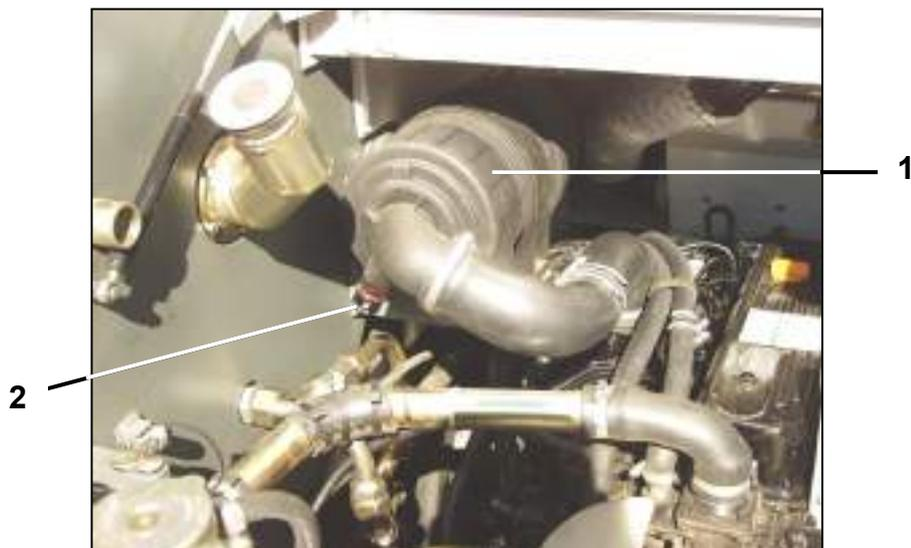
Рис. 34– Местонахождение воздушного фильтра
