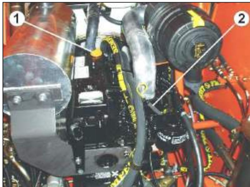
**Рис. 32 Заливка масла в двигатель (1), контрольный щуп (2)**
