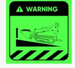
**WARNING: OVERTURNING** THE MACHINE AS A RESULT OF IMPROPER OPERATION
