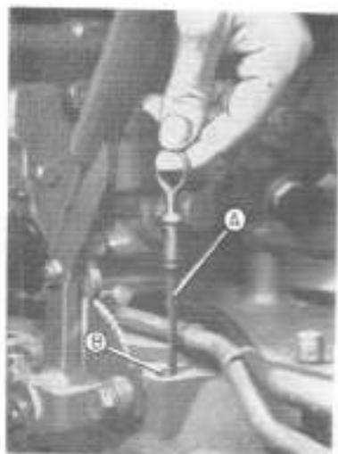
25. Vérification du niveau de l'huile du carter de la transmission. Se fait à l'aide de la tige A. Si nécessaire, alimenter avec de l'huile indiquée page par l'orifice B de la fig.
