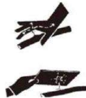
1-9 Утечка гидравлического контура
