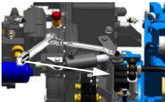
Abb. 15 Entlasten der Zapfwellenkupplung
