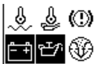
Abb. 5 Störungsanzeige in der Standardanzeige obere Reihe von links: Kühlwassertemperatur zu hoch; Motoröltemperatur zu hoch; Niveau Bremsflüssigkeit zu tief untere Reihe von links: fehlende Batterieladung; Motoröldruck zu tief; Luftfilter verstopft (Störungen werden invers dargestellt)
