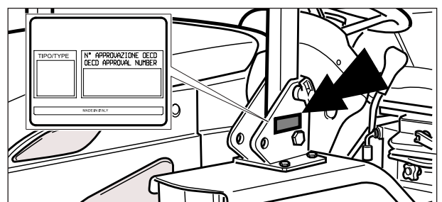
Fig. 76a - Placa de estructura de protección antivuelco
