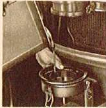
35. Cambio de aceite en el filtro de aire.
