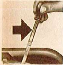
3. Comprobar nivel de aceite en elevador hidráulico.
