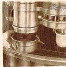
4. Comprobar nivel de aceite en el filtro de aire.
