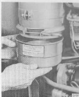
Fig. 23. Kontroll av luftrenare.
