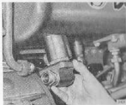
Fig. 38. Demontering av sugsil.
