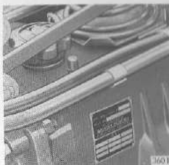
Fig. 32. Oljepåfyllningslock och mätsticka på växellådan samt typbeteckningskyllt.
