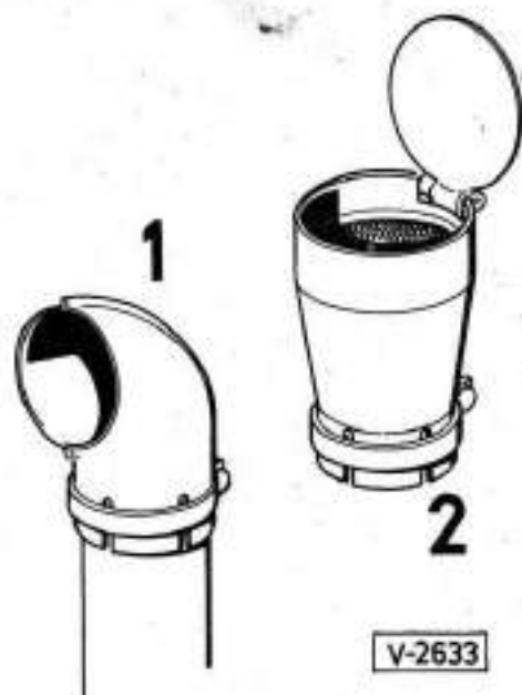
6-14. ábra. A szikrafogó felszerelése. /V-2633/
