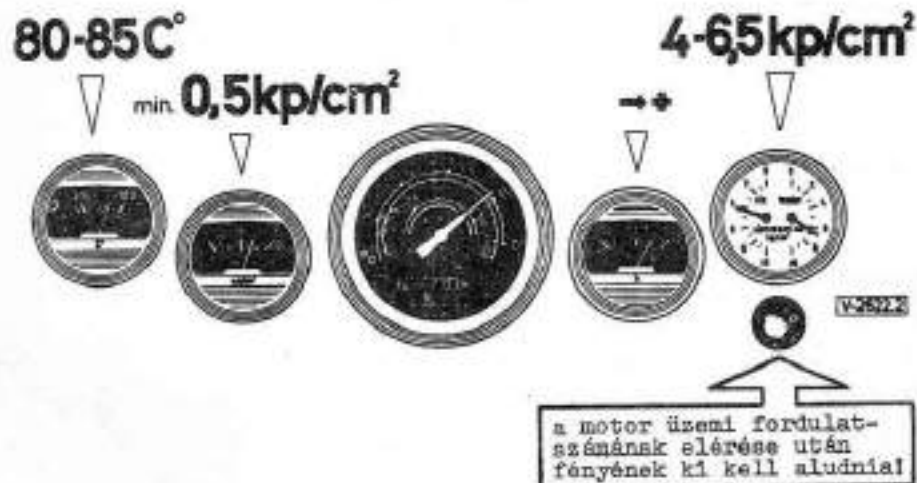
3-17.ábra. A motor működésének ellenőrzése. /V-2622.2/
