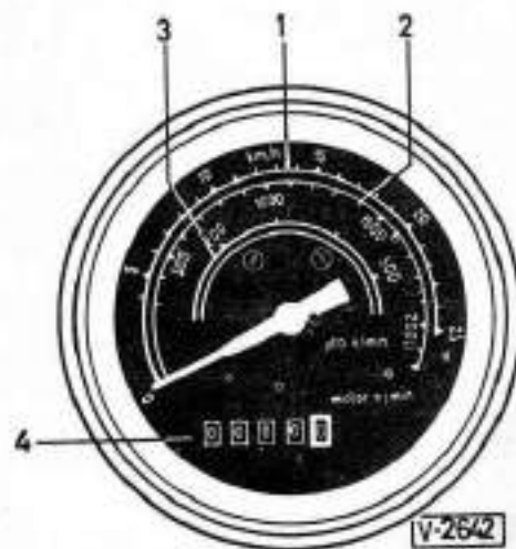
3-8. ábra. Elektronos üzenőraszámoló és fordulatszám-jelző műszer. /V-2642/
