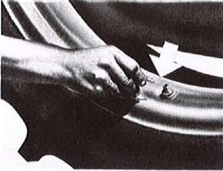
Para vaciar los neumáticos de agua, se colocará la rueda según se indica.
