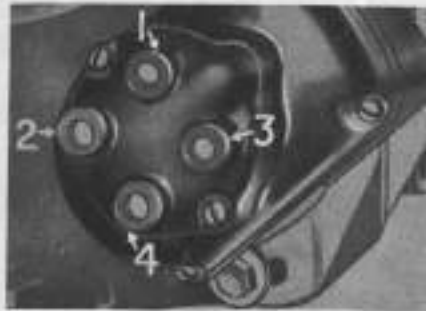
Fig. MH 244—Magneto wiring, models 101 Jr., 102 Jr. and 102 G. Jr.
