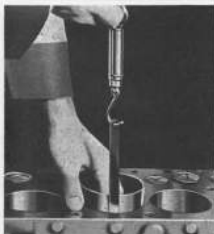
Fig. MH142—Checking piston fit.
