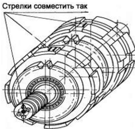
Рисунок 59 – Установка гидropоджимных муфт
