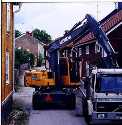
EW150 utrustad med ställbar bom är lämplig för arbeten i trånga gränder.
