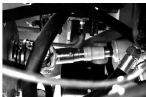
Fig. 5-5 Posición de lubricación de eje de transmisión maestro
