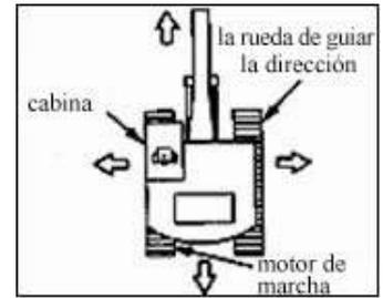
**⚠ Atención:** la posición estándar de marcha es: polea guía están delante de la máquina, el motor de marcha y la polea de impulsión, detrás de la máquina. Si el motor de marcha está en la frente de la máquina, la función del control del estribo de marcha resultará contraria. Antes de andarse, asegúrese la posición del motor de marcha.
