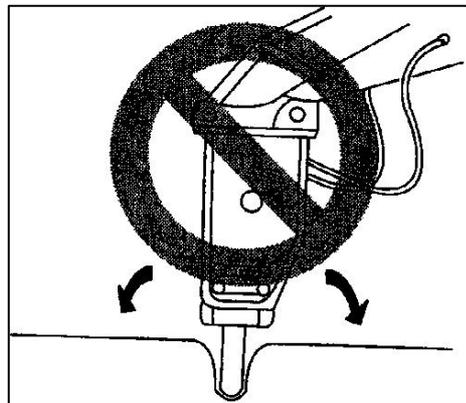
Al levantar el mecanismo, no extiendan el cilindro de pala por lo máximo.
