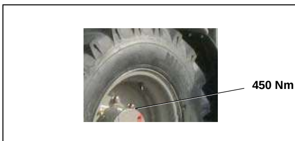
Abbildung 116 Radmuttern nachziehen
