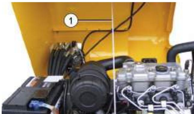
Die Sicherungsleine **1** hält die Motorhaube in Position.
