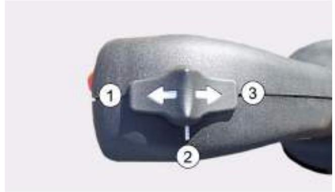
Wählen Sie die Fahrtrichtung am Bedienhebel.
