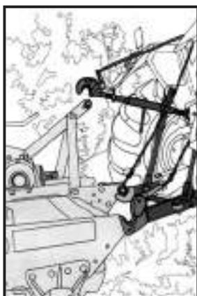
Für die Entkupplung nach Beendigung der Arbeit das Gerät am Boden aufsetzen, mit Hilfe des Kommandogriffs den Haken des Oberlenkers entkuppeln und den Oberlenker im entsprechenden Halter des Traktors befestigen.
