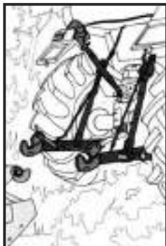
Den Traktor mit dem Gerät annähernd ausrichten.
