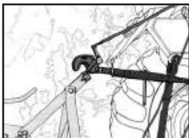
Die Länge des Oberlenkers auf den entsprechenden Abstand einstellen, sodaß sich der Haken über dem Bolzen des Gerätes befindet.
