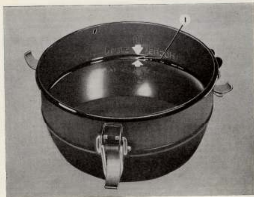
Kuva 5. Ilmanpuhdistimen öljysäiliön öljymäärä. 1. Öljypinnan korkeus.
